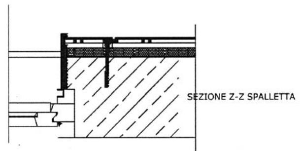
PARTICOLARE DELLE GIUNZIONI TRA FINESTRE E RIVESTIMENTO ESTERNO CON FINITURE IN LAPIDEO
