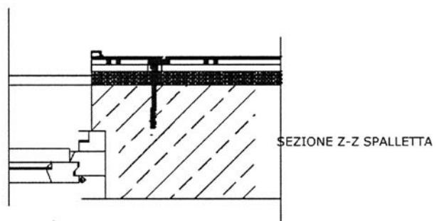
PARTicolare delle giunzioni tra finestre e rivestimento esterno con finiture in alluminio
